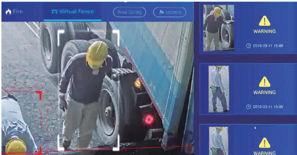
「煤倉入口 AOI 辨識系統」偵測到人員異常狀況可即時反應
